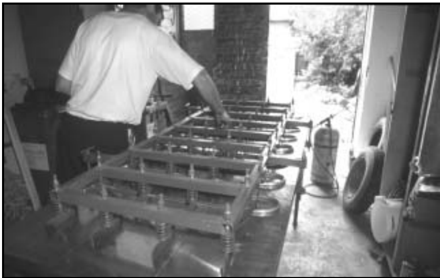
Kollektor-készítés a műhelyben
